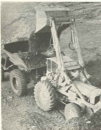
Traktor med to-vejs læsseskovl. Standardtraktor med graveskovl på efterhængt basiskonstruktion. Leves også med smal ske til gravning af fundamentsrender.
