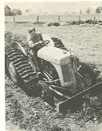
Standardtraktor med ekstra bælter og planérblad.
