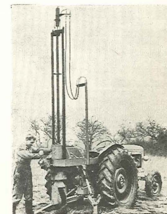
Standardtraktor med muldsluffe. Roterende jordbor til udgravning af huller for fundamentsklodser.
