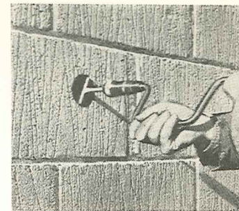
Hulboringsværktøj til letbeton.
